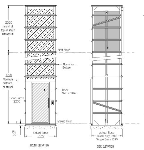
Actual Base 1575 Actual Base <u>1400</u> 1590 Front-Entry A MODEL - Single Car Entry Elevation Actual Base <u>1575</u> Fntrv <u> 65</u> Door Actual Base 1400 605 1590 Front-Entry
